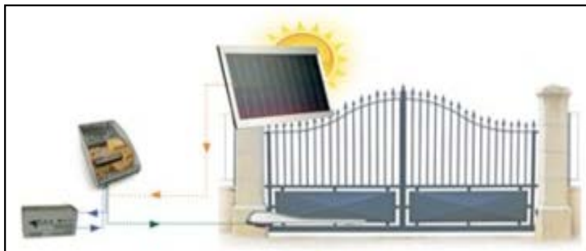
Fig. 1 - Esempio di kit movimentazione cancello con alimentazione da pannello fotovoltaico. Immagine tratta da www.apritu.it
