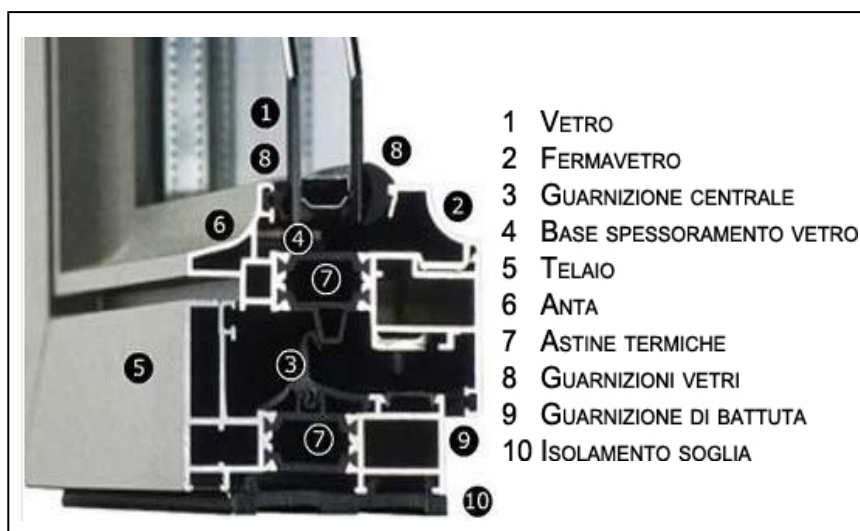
Fig. 2 - Profilo di infisso in alluminio a taglio termico. Immagine tratta da lanzonifabrizio.com
