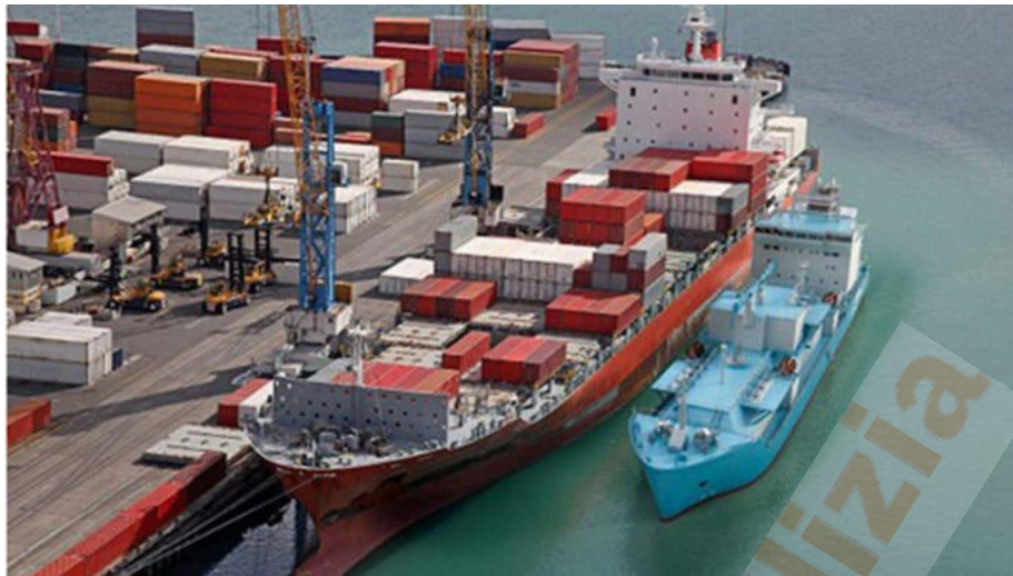
Fig. 4.2: Bunkeraggio STS (tratto da Linee Guida EMSA)
