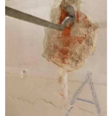
La prova è stata condotta con l'ausilio di un martinetto operante a tiro, posizionato a ridosso della muratura in modo tale da imporre alla barra in prova una forza quasi esclusivamente tagliante.
