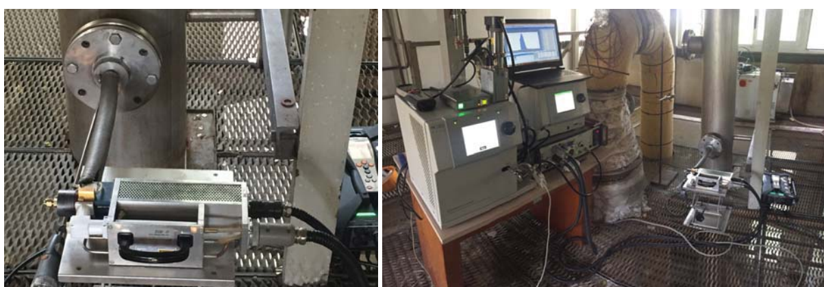
Figura 4.4 – Dettagli del sistema di campionamento e misura delle polveri sub-micrometriche al camino.
