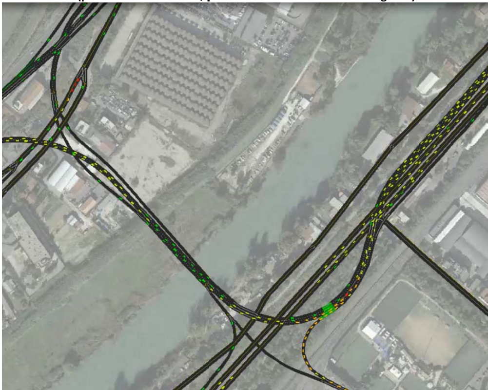
Figura 7-102: Analisi trasportistica micro - Flussi veicolari nell'ora di punta del mattino nello scenario "con" progetto (particolari a 30 minuti, particolare nuovo Ponte dei Congressi)
