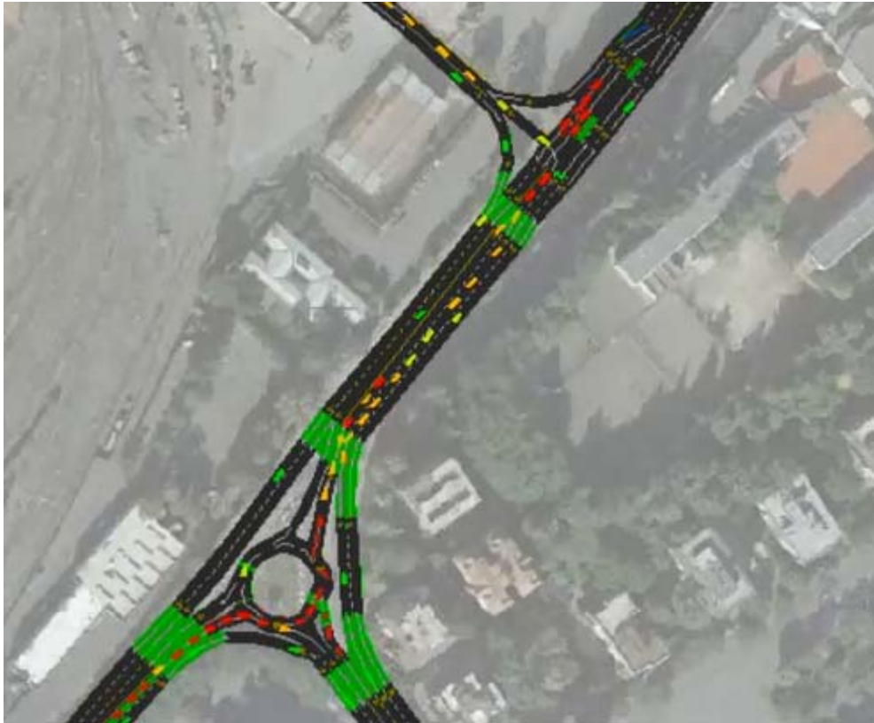
Figura 7-13: Analisi trasportistica micro - Flussi veicolari nell'ora di punta nello scenario "con" progetto (particolare a 30 min. innesto/uscita su V.le Egeo e Rotatoria degli Oceani)
