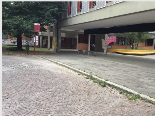
Via George Gordon Byron – fermate con altezza inadeguata, prive di palina intelligente, segnaletica podotattile, pensilina e sedute
