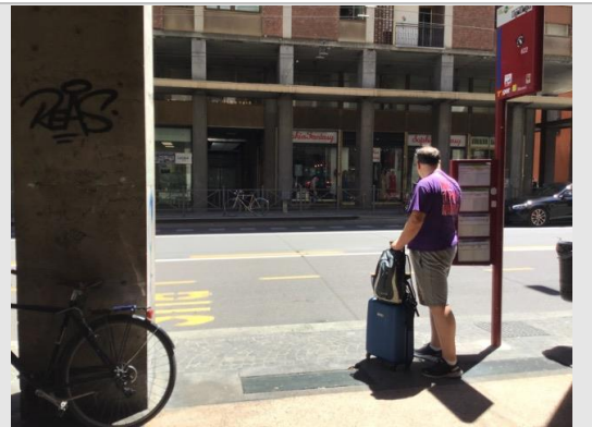
Via Guglielmo Marconi – Percorso pedonale esterno al porticato con fermata priva di segnaletica podotattile, palina intelligente, tettoia e sedute
